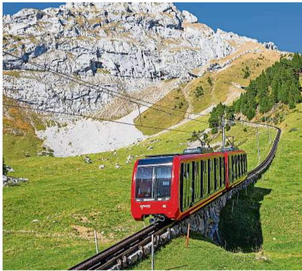
Bis zu 48 Prozent Steigung bewältigt die Zahnradbahn auf den Pilatus.
